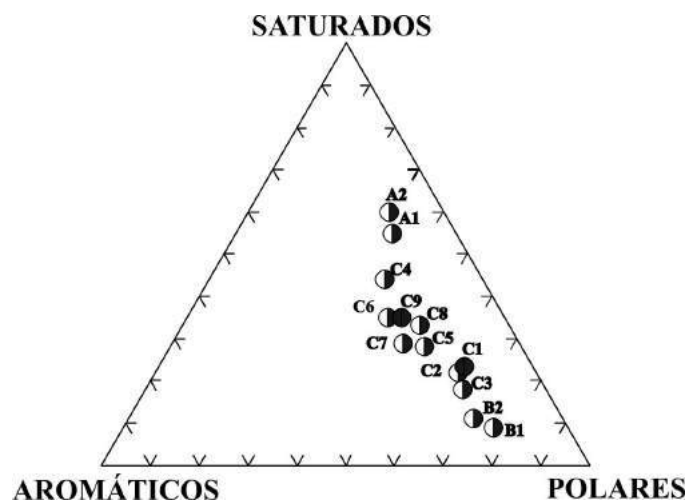
Figura 2. Composição química dos betumes extraídos das amostras em porcentagem de compostos saturados, aromáticos e polares (resinas e asfaltenos).
